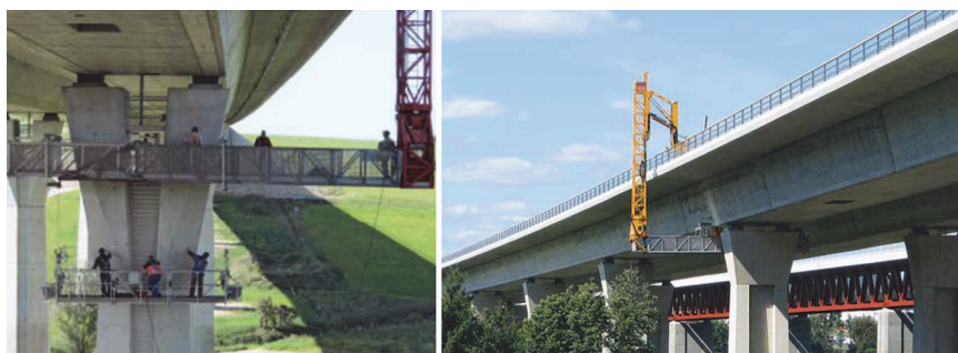
Slika 12. Primjeri specijalnih dizalica za pregled mostova [29]
