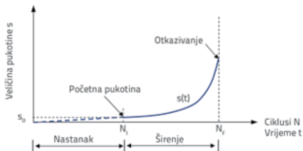
Slika 1. Rast pukotine s brojem promjena ciklusa opterećenja
