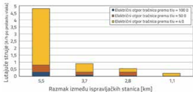
Slika 29. Smanjivanje lutajućih struja ostvareno povećanjem električnog otpora između tračnice i tla te manjim razmakom između ispravljačkih stanica [20]
