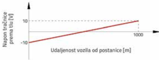
Slika 15. Razlika potencijala u tračnici kada se na dionici nalazi jedno vozilo na udaljenosti 1000 m od ispravljačke stanice
