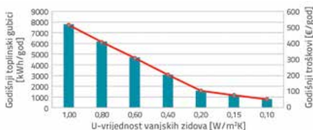
Slika 3. Utjecaj U-vrijednosti vanjskih zidova na godišnje toplinske gubitke jednoobiteljske kuće (površine vanjskih zidova 100 m²) u klimi središnje Europe
