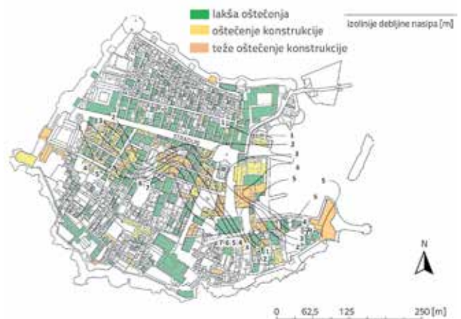
Slika 9. Izolinije debljine nasipa (od 1 m do 7 m debljine) u Starom gradu u Dubrovniku, preklopljene s prikazom oštećenja građevina za potres iz 1979. godine, modificirano iz [35]
