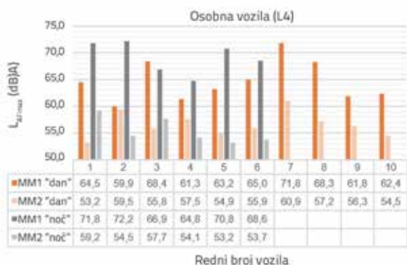
Slika 15. Rezultati mjerenja buke pojedinačnih vozila na lokaciji L4
