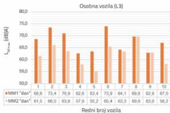
Slika 14. Rezultati mjerenja buke pojedinačnih vozila na lokaciji L3
