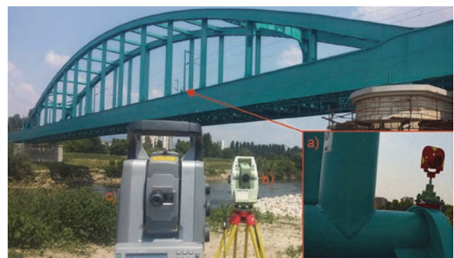
Slika 2. Položaj RTS-a i reflektora: a) reflektor; b) RTS 1; c) RTS 2
