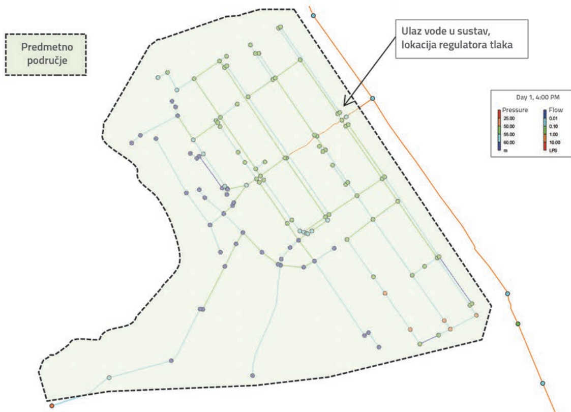
Slika 11. Shematski prikaz analiziranog vodoopskrbnog sustava (izvod iz kreiranog Epanet modela)
