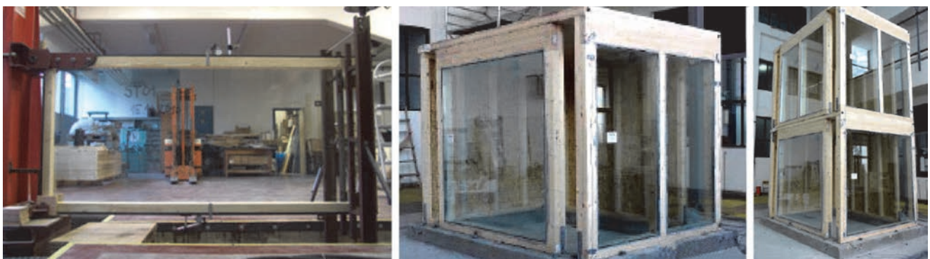
Slika 8. Kompozitni sustavi predstavljeni u radu Bera i ostalih [26-31]; monotona ispitivanja i ispitivanja na potresnom stolu
