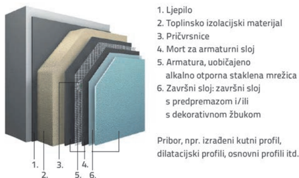
Slika 1. Komponente ETICS sustava [3, 4]
