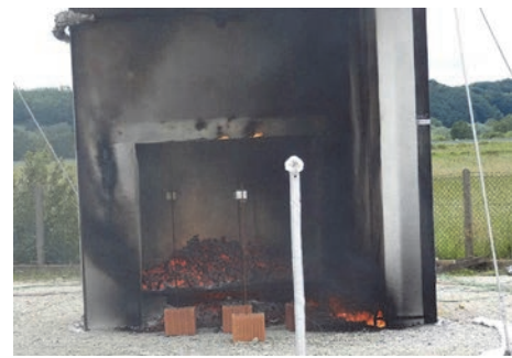
Slika 14. 54 minute nakon početka – tinjanje uzorka EM_2
