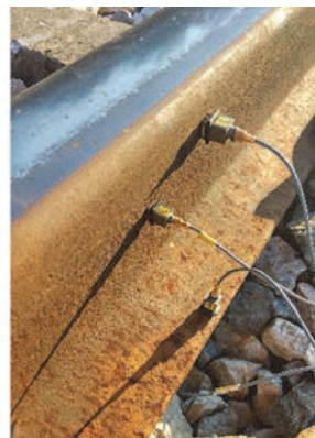
Slika 12. Pozicije akcelerometara na poprečnom presjeku tračnice za mjerenje stupnja prigušenja vibracija, te smjer unosa sile u horizontalnom i vertikalnom smjeru
