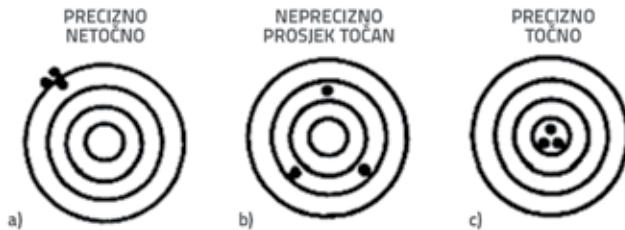
Slika 10. Shema tumačenja točnosti i preciznosti prema Dunclicliffu [29]
