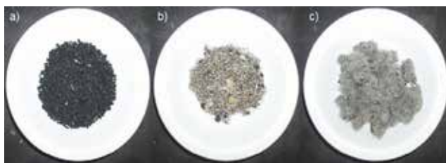
Slika 1. Proizvodi reciklaže otpadnih automobilskih guma: a) gumene granule, b) čelična i c) tekstilna vlakna
