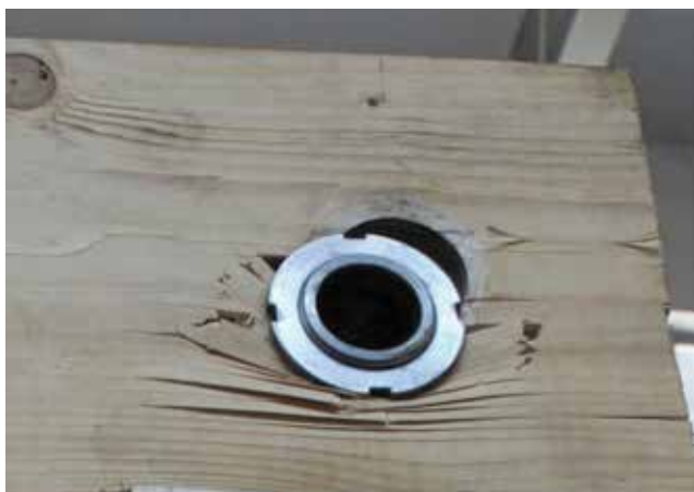
Slika 10. Deformacija rubnog priključka druge rešetke
