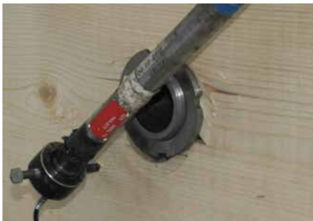
Slika 9. Deformacija srednjeg priključka druge rešetke
