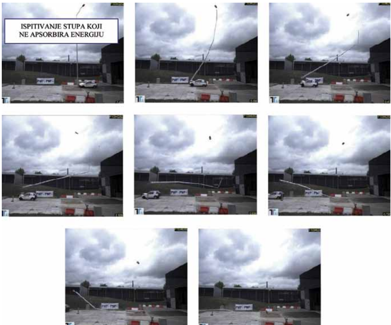
Slika 6. Prikaz pokusnog sudara s pasivno pouzdanim neapsorbirajućim stupom [6]
