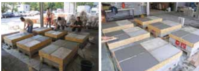
Slika 7. Svježe ugrađeni reprofilijski betoni na površinama svih 6 blokova
