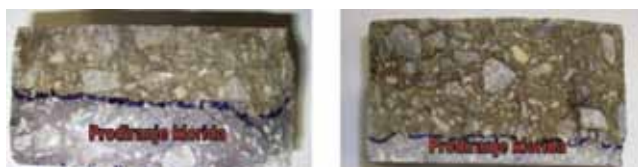
Slika 6. Dubina prodiranja klorida kod mješavine SCC (lijevo) i mješavine SCC-FMP (desno)
