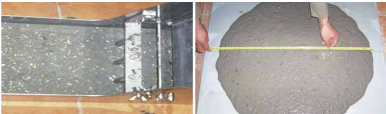
Slika 2. Ispitivanje samozbijajućeg betona pomoću L-kutije (lijevo) i konzistencija rasprostiranjem (desno)
