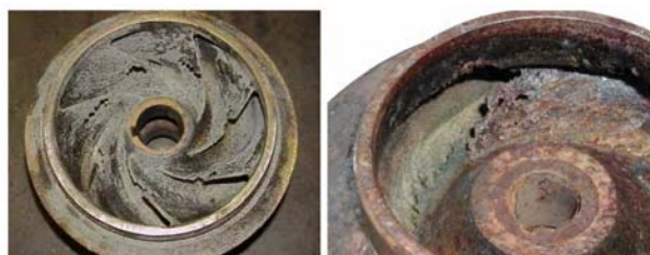
Slika 2. Tipična kavitacijska oštećenja rotora centrifugalnih crpki [7], [8]
