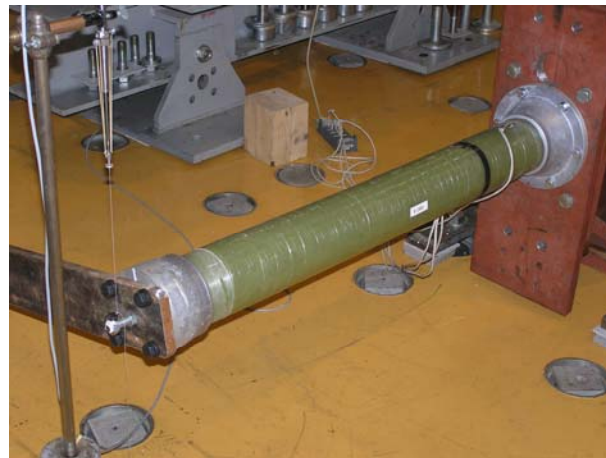
Slika 12. Uređaj i oprema pri ispitivanju cijevi pri složenom opterećenju
