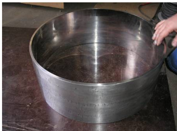
Slika 13. Prsten ćelije od nehrđajućeg čelika
