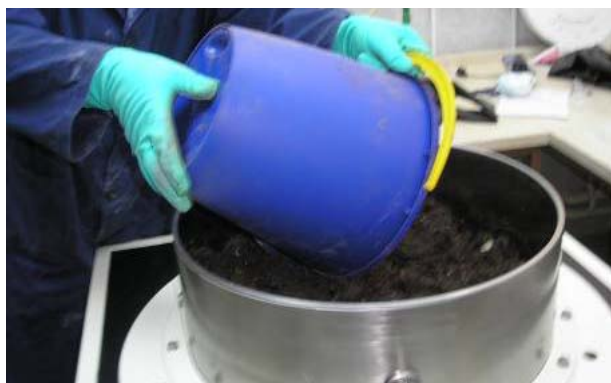
Slika 18 Nasipavanje novog sloja uzorka u edometarsku ćeliju
