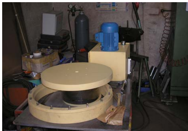
Slika 12. Pokretna ploča s vodicom
