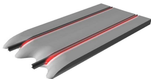
Slika 19. Shematski prikaz kolosijeka s elastično obloženim tračnicama
