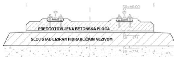
Slika 14. Poprečni presjek pločastog kolosijeka tipa „Bögl“ [9]
