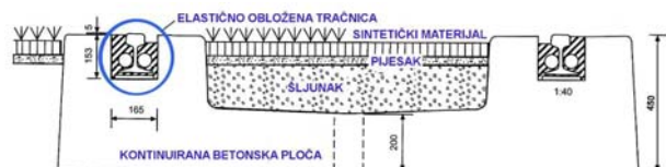
Slika 20. Poprečni presjek kolosiječnog sustava „INFUNDO“ [1]
