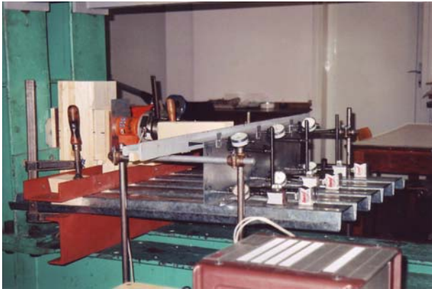
Slika 3. Eksperimentalno određivanje rotacijske krutosti C_{D,A}
