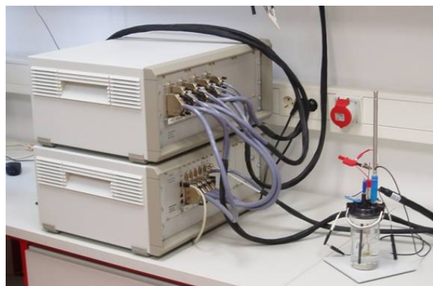
Slika 4. Sustav za elektrokemijska ispitivanja korozijske otpornosti
