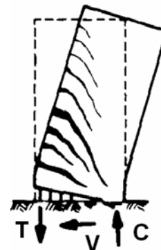
Slika 1. Mehanizam sloma visokog zida [1]
