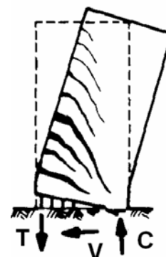
Slika 1. Mehanizam sloma visokog zida [1]
