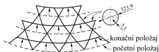
Slika 3. Oblikovanje rešetkaste kupole
