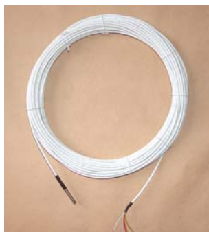
Slika 2. Pt-100 sonda za mjerenje temperature
