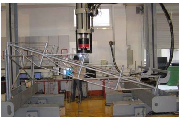
Slika 8. Ispitivanje glavnog nosača tribina u laboratoriju
