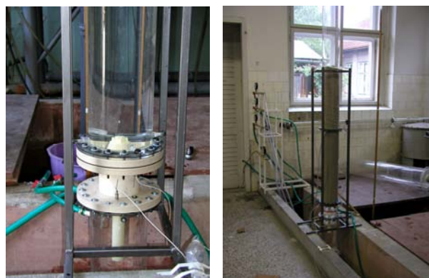
Slika 3. a) ugrađena filtarska sapnica, spojevi piezometara i elektroničkih tlakomjera na fiksno postolje, b) ugrađeni filtarski materijal iznad podnice
