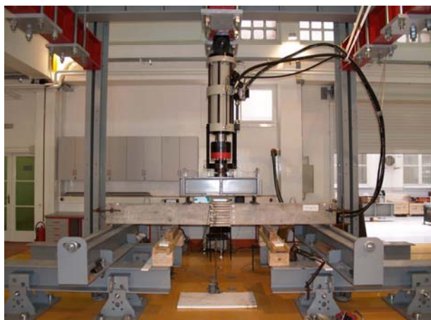
Slika 2. Uzorak grede u uređaju za ispitivanje
