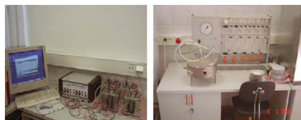
Slika 7. Ispitivanje difuzije iona klorida (lijevo) i plinopropusnosti (desno)
