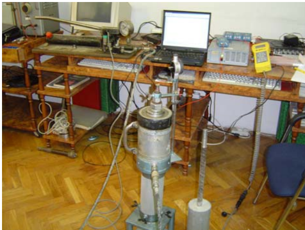
Slika 4. Oprema za izvođenje pokusa čupanja u laboratoriju [3]
