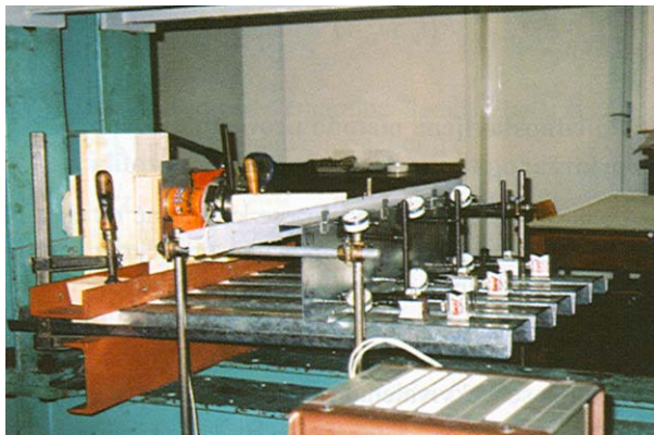
Slika 10. Eksperimentalno određivanje stupnja bočne (torzijske) krutosti
