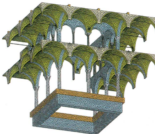
Slika 15. Detaljni numerički model atrija. Zbog jasnoće slike ležajevi i opterećenje nisu prikazani
