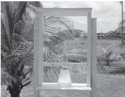
Slika 1. Wet candle mjerna postaja [1]
