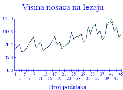
Slika 8. Prikaz rezultata stvarnih (Actual(3)) i naučenih (Network(3)) parametara visina lameliranih nosača na ležaju. Rezultati se izvanredno podudaraju
