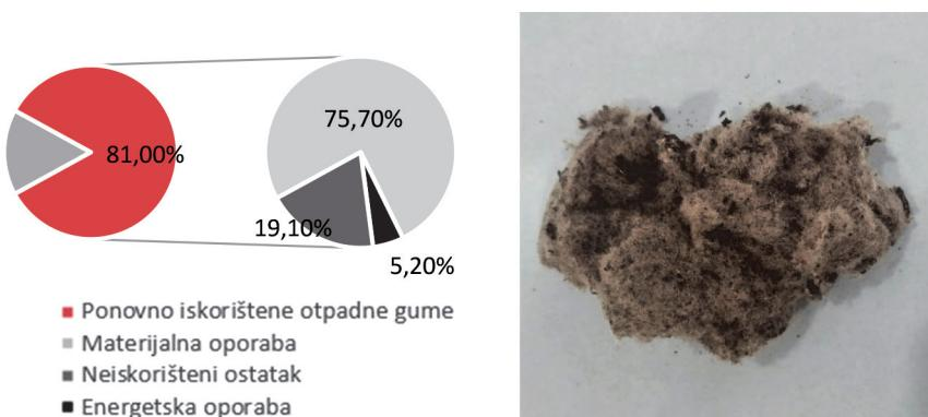
Slika 2. Odnos vrsta ponovnog iskorištanja otpadnih guma u Hrvatskoj (lijevo); onečišćena polimerna vlakna dobivena recikliranjem otpadnih guma (desno)
