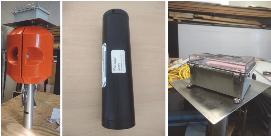
Slika 4. ScourBuoy (1. prototip) (lijevo), dubinomjer Echologger EA400 (sredina), vodootporno kućište s mobitelom (desno)
