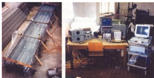
Slika 5. Ispitivanje trapeznog LIMA 1, uzorak (lijevo) i mjerni instrumenti
