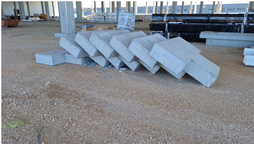
Slika 19: Mehanički lom fasadnih dokova
