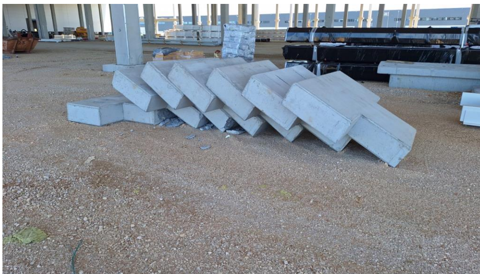
Slika 19: Mehanički lom fasadnih dokova
