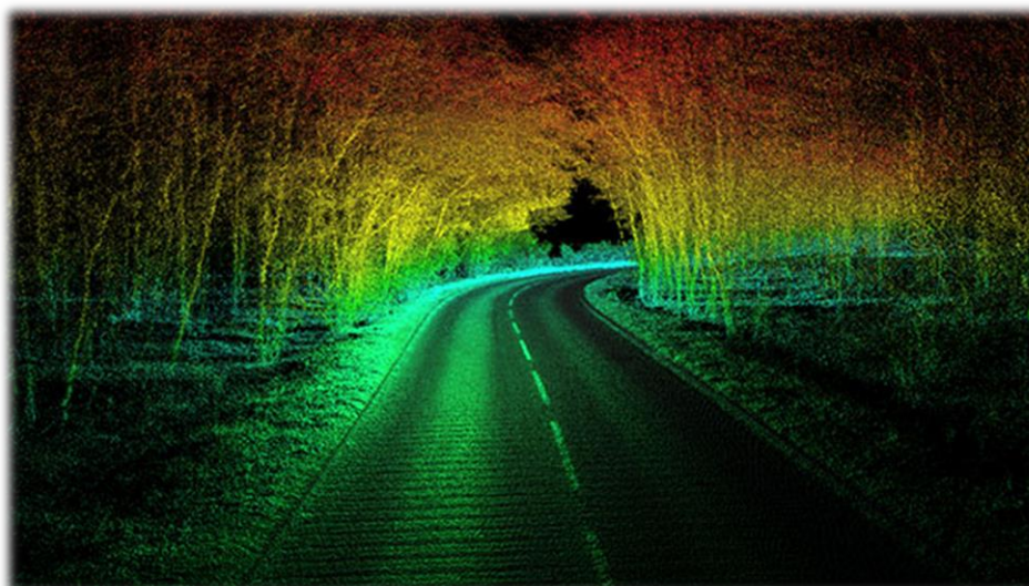
Slika 4. Prikaz oblaka točaka registriranih pomoću LiDAR senzora [20]
