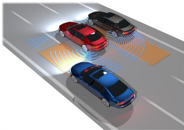
Slika 9. Praćenje vozila korištenjem ultrasoničnih senzora [31]
