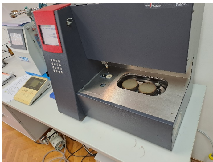
Slika 19: Mjerenje vremena vezivanja automatskim Vicatovim aparatom
