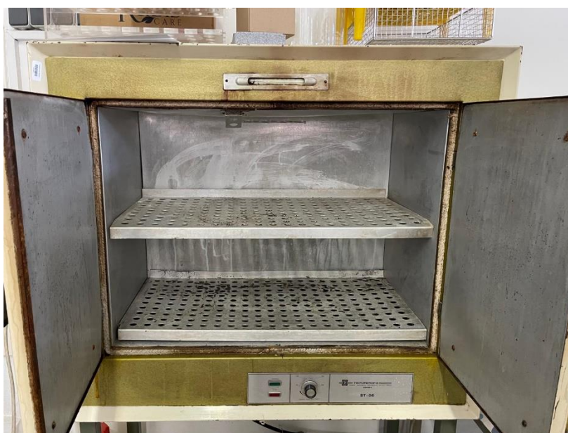
Slika 11: sušionik za sušenje elektroda (Instrumentaria ST-06)
