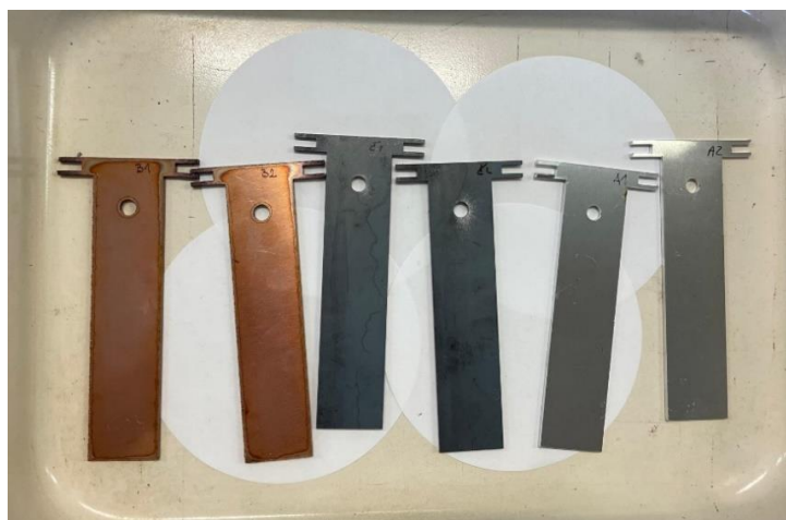
Slika 7: Elektrode od bakra, željeza i aluminija
