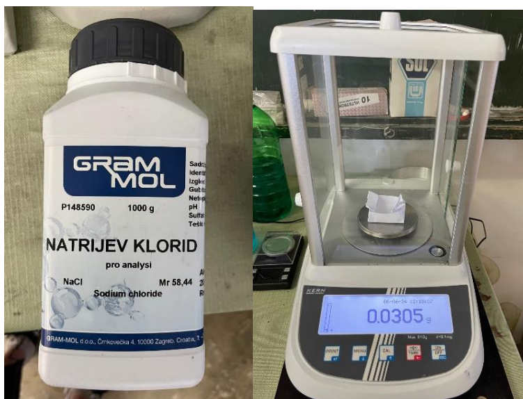
Slika 5: NaCl i analitička vaga (KERN ALJ500-4A)
