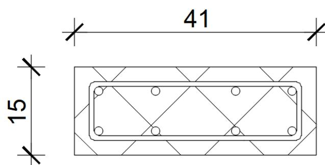
*Slika 17. Poprečni presjek sekundarnog nosača u presjeku 3-3*
