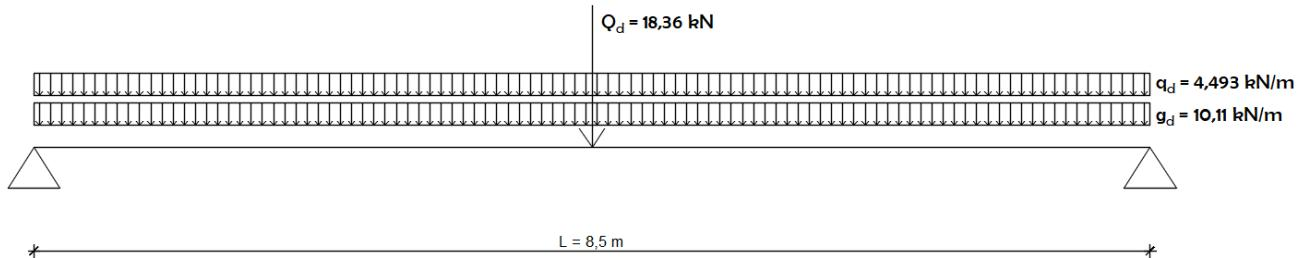
Slika 35. Opterećenje ploče
