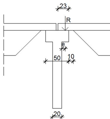
Slika 25. Oslanjanje sekundarnog nosača na glavni nosač
