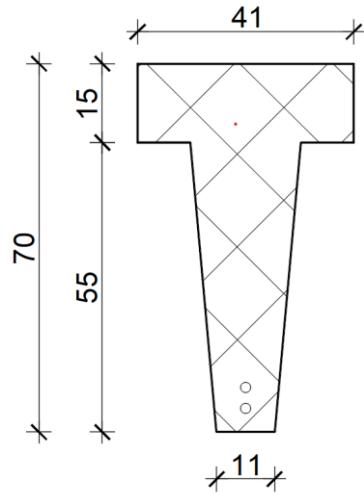
Slika 15. Poprečni presjek sekundarnog nosača u presjeku 2-2
