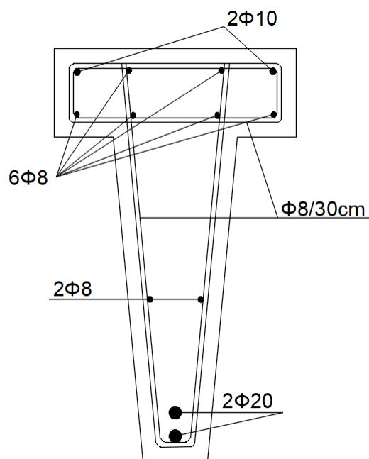
Slika 16. Raspored armature u poprečnom presjeku sekundarnog nosača
