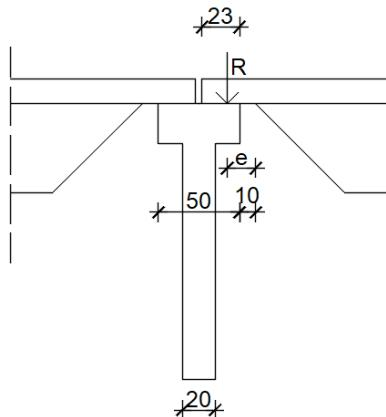
Slika 19. Oslanjanje sekundarnog nosača na glavni nosač
