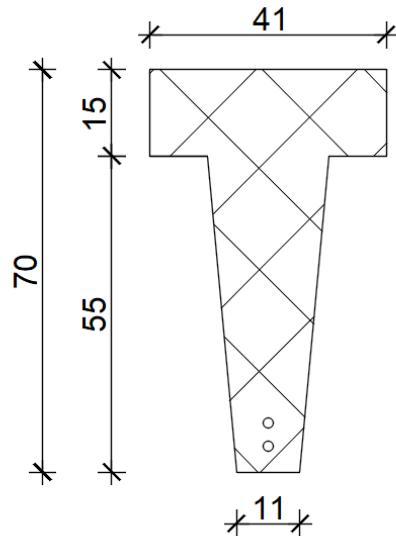
Slika 14. Poprečni presjek sekundarnog nosača u presjeku 1-1
