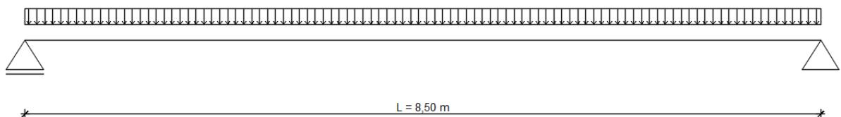
Slika 29. Statički sustav rebraste ploče
