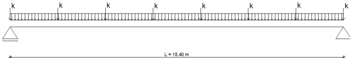
Slika 45. Statički sustav glavnog stropnog nosača
