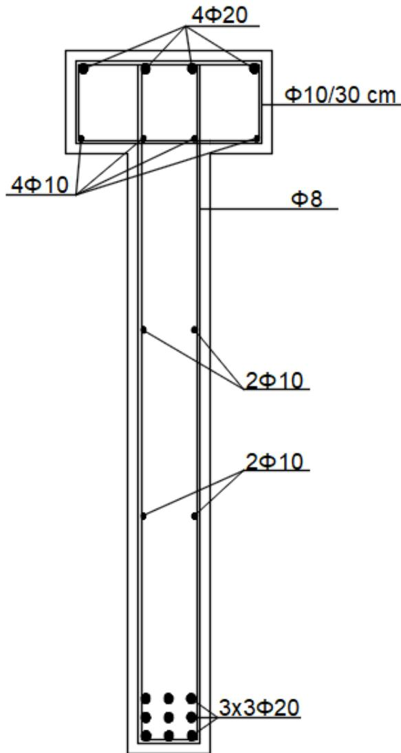
Slika 26. Raspored armature u poprečnom presjeku glavnog nosača
