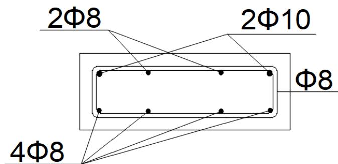
Slika 18. Raspored armature u poprečnom presjeku sekundarnog nosača
