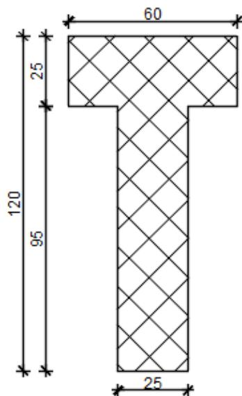
Slika 44. Poprečni presjek glavnog stropnog nosača
