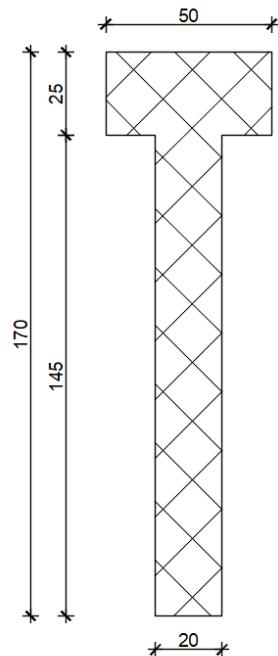
Slika 21. Poprečni presjek glavnog nosača
