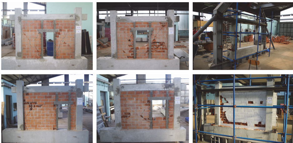
Slika 2. Ispitane u mjerilu 1:2,5 izvedene modelske armiranobetonske okvirne konstrukcije s ispunskim zidom u kojemu se nalaze omeđeni otvori, i zidne bez otvora (Penava, 2012; Sigmund and Penava, 2014)
