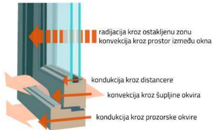
Slika 10.: Gubitak topline radijacijom, kondukcijom i konvekcijom. (Izvor: [14])
