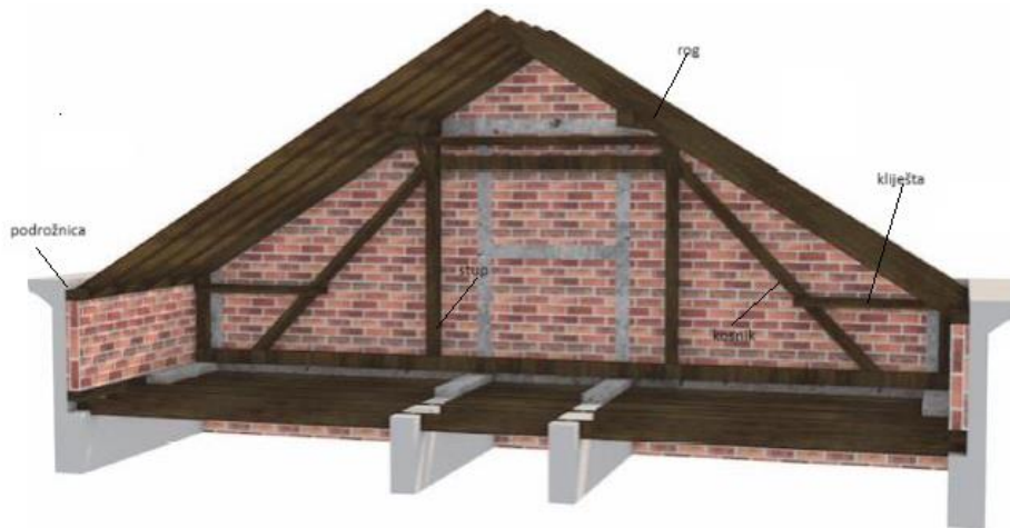
Slika 1.: Elementi nosive drvene krovne konstrukcije (Izvor: [15])
