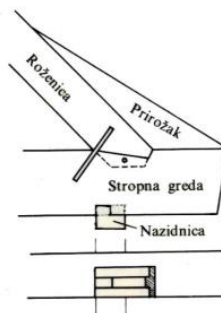
Slika 44.: Spoj roga i grede zasjekom s čepom (Izvor: [2])
