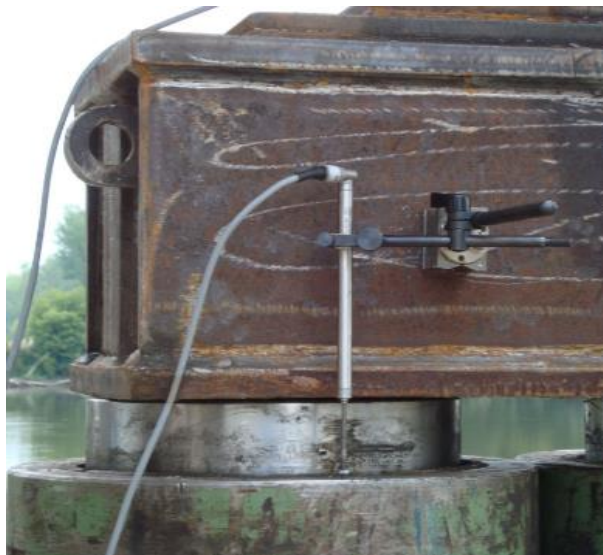
Slika 9: Mjerenje pomaka induktivnim osjetilom [1]
