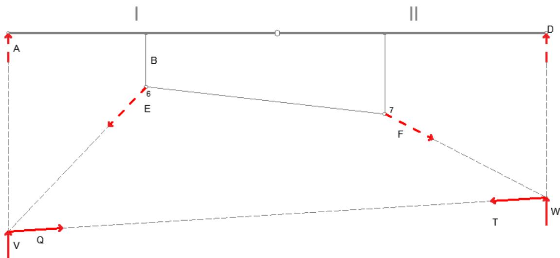
Određivanjem sjecišta pravaca sila A i E, kao i D i F, dobivamo točke na temelju kojih se određuju reakcije i unutarnje sile u sistemu. Uz uvjet ravnoteže momenata za cijeli sistem, dobivaju se vrijednosti sila potrebne za stabilnost sistema.
