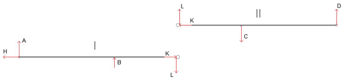
Sile koje djeluju na zglobovima mogu se prikazati pomoću horizontalnih i vertikalnih komponenti. Koristeći projekciju svih sila na os koja je okomita na zglobne štapove, određujemo nepoznate sile  $H$  i  $K$  za svaki od dva sistema. Iz uvjeta ravnoteže sila za tijelo I određuje se sila  $H$ , dok se za tijelo II određuje sila  $K$ .
