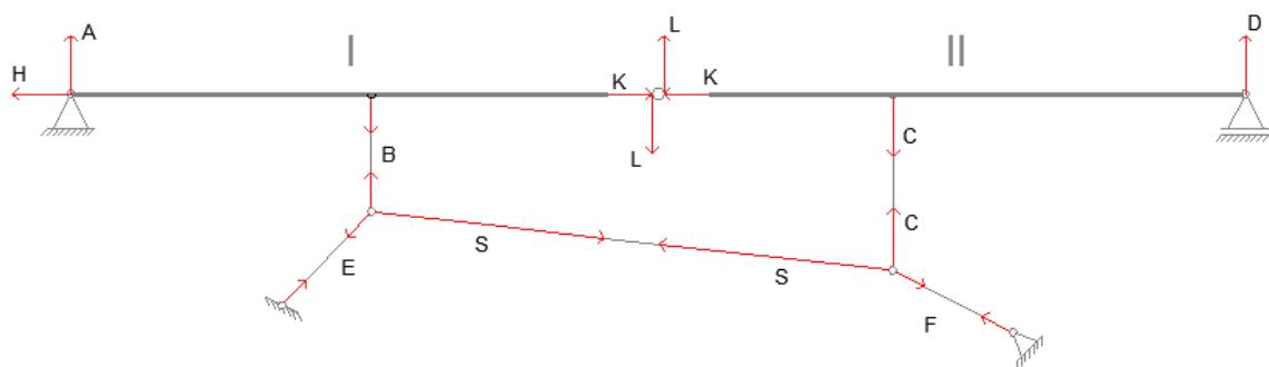
Rješenje se postavlja pomoću prikladnog rastavljanja sila u spojevima. Djelovanje nepomičnog zgloba prikazano je s dvije sile, pri čemu jedna leži na spojnici zglobova, a druga je paralelna sa zglovnim štapovima. Djelovanje pomičnog zgloba prikazano je jednom silom, paralelnom sa zglobnim štapovima.
