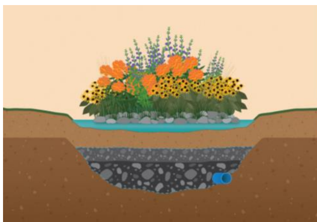
Slika 9.: Odvodnja oborinskih voda za vlasnike okućnica (Izvor: [6])
