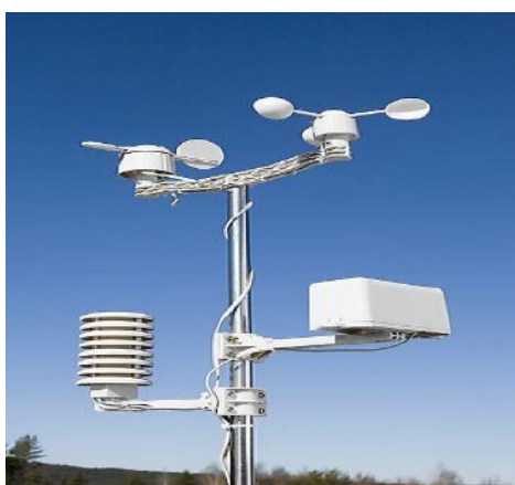
Slika 14: Osobna meteorološka stanica (izvor: [41]).
